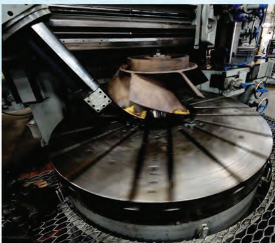
Machining Impeller OD on VTL
